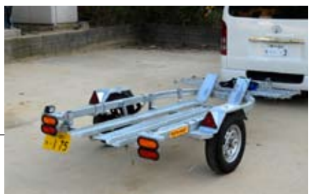
ジェットスキー用を水道用部品などで改造した特性HP2用キャリアー
