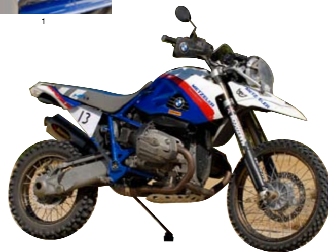
1.車体には電気を効率よく電送系パーツに送るアーシングシステムが施されている2.マフラーはアクラポビッチのスリップオンを装着。BMWの純正品としても採用され、その性能は折り紙付きだ3.タイヤ自体の強化を図るためチューブレスタイヤにもチューブを挿入する4.フレームやステップガードの傷を防止しているのは水道用の強化パイプ。永田さんならではの
